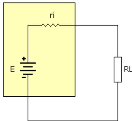
Se a resistência da carga variar, com tendência a valores muito baixos, a maior parte da potência ficará retida na resistência interna da fonte ( $r_i$ ).
