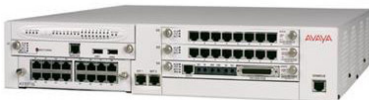
Exemplo de hardware Media Gateway – G700 da Waycom: interconecta redes TDM (GSM/EDGE) e redes IP
