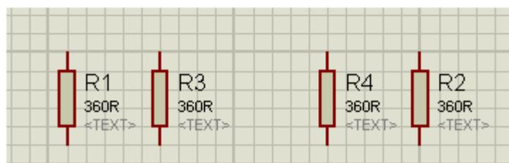
→ Mantendo o botão esquerdo do mouse pressionado, é possível movimentar o componente no sentido horizontal e vertical, com o auxílio das “setas esquerda/direita e para cima/para baixo”. Obtém-se assim melhor precisão no posicionamento do componente.
