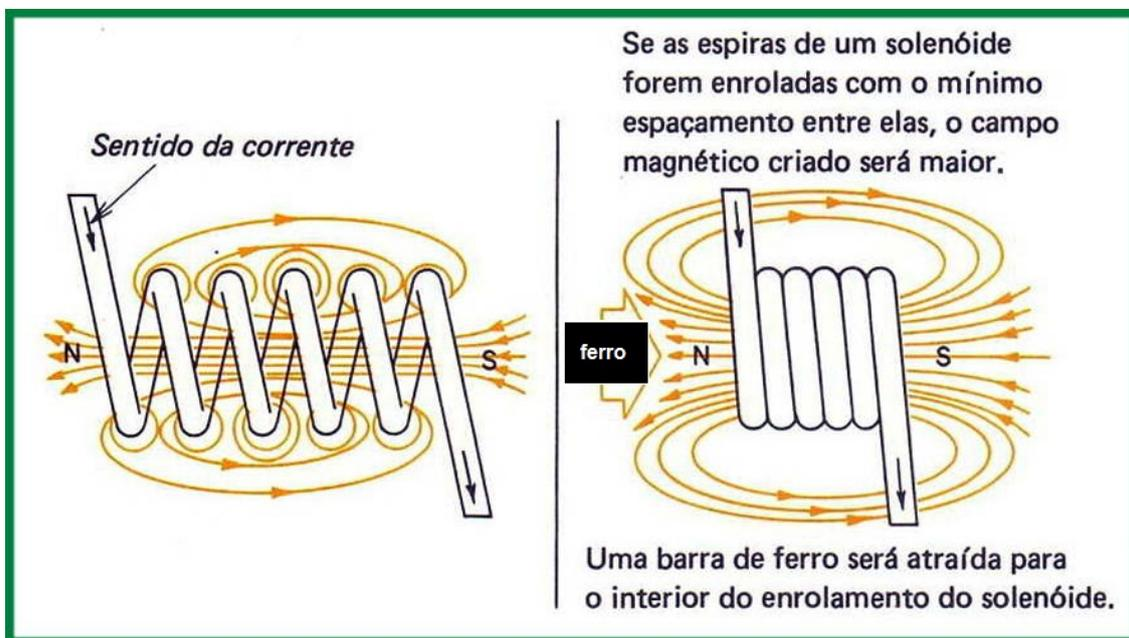
As linhas de fluxo fazem com que o solenóide se comporte como um ímã, com polaridades definidas, em função do sentido de corrente.
