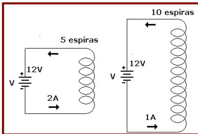
Em ambas as bobinas a força magnetomotriz é igual a 10Ae, pois:
