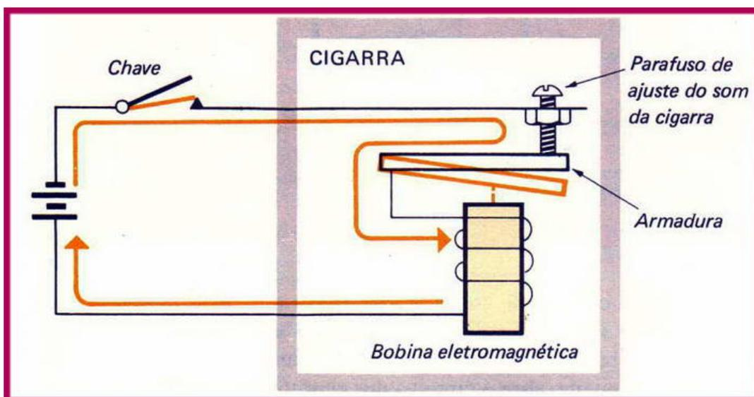
Quando a chave é fechada a corrente flui através do parafuso de contato e a bobina, energizando a bobina. Diferentemente do que ocorre no relê, os contatos são posicionados de forma que a bobina não fique continuamente energizada.
