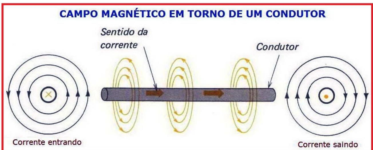
O sentido do campo magnético ao redor do condutor depende do sentido da corrente. Uma bússola colocada nas proximidades do fio terá a sua agulha orientada no sentido das linhas de fluxo.
