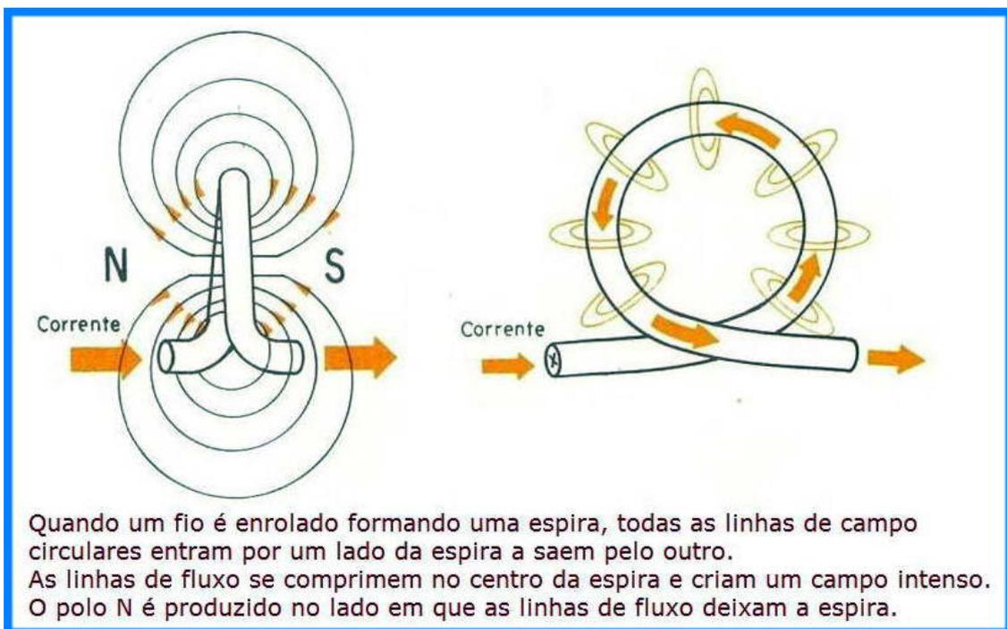
Observe na figura à esquerda que as linhas se concentram no centro da espira, produzindo campos magnéticos com respectivas polaridades, sendo que o N é formado no lado em que a corrente entra e o S, no lado em que a corrente sai.
