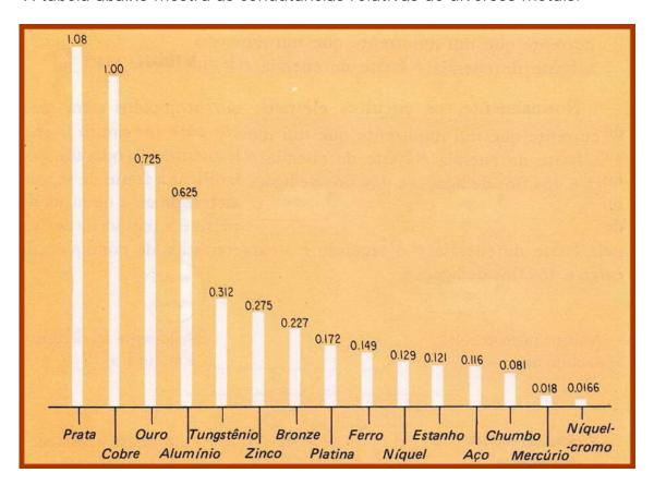
A condutância é o inverso da resistência, ou seja, quando menor for a resistência de um material, maior será a condutância.
