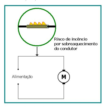
Além do risco de incêndio, o excesso de corrente poderá danificar também a fonte de energia.
