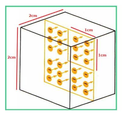
Conclusões: 1) Aumentando o comprimento do condutor, mantendo a mesma área da secção transversal, a resistência aumenta; 2) Aumentando a área da secção transversal do condutor, sua resistência diminui.
