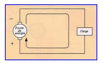
O sentido de corrente adotado é o sendo real da corrente, ou seja, do negativo para o positivo. Observe que se trata de um circuito completo ou fechado, onde pela carga circula uma corrente.
