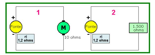
Desprezando a resistência do fio, temos no circuito 1 uma resistência total de 11,2 ohms.
