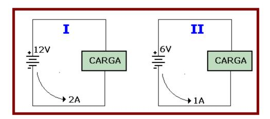
Se a carga nos dois circuitos for exatamente igual, a corrente que circulará pelo circuito II terá a metade do valor.
