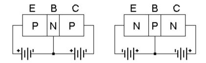
Analisando a figura acima, verifica-se que é muito importante então a forma de polarizar as junções e sua respectiva representação.
