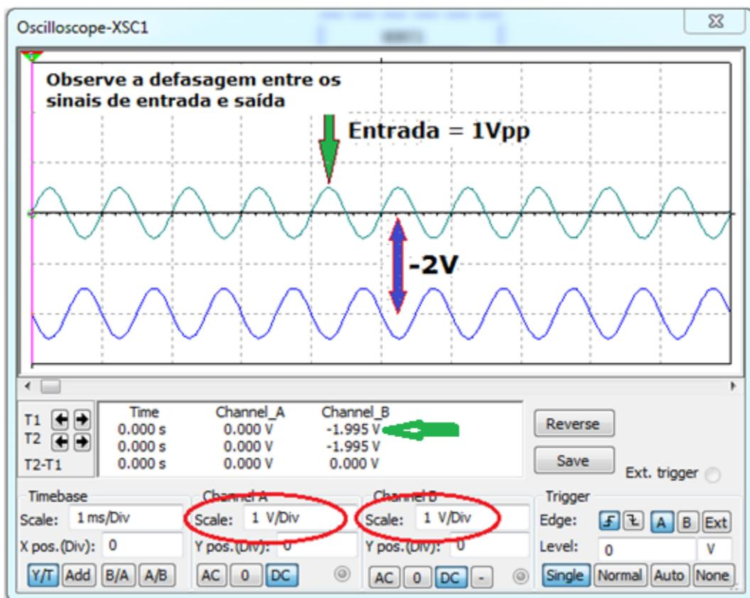
Ao inverter a polaridade da bateria de 2V aplicada na entrada o sinal de saída se deslocará 2V acima do eixo de referência.
