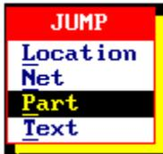
**JUMP:** Permite um acesso imediato a qualquer parte do esquema, através de uma listagem de componentes, ligações, textos, etc.
