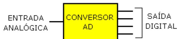
Uma das formas mais simples para se converter sinais analógicos em sinais digitais é a utilização de circuitos chamados *FEEDBACK CONVERTERS* ou conversores por realimentação, utilizando conversores DA.
