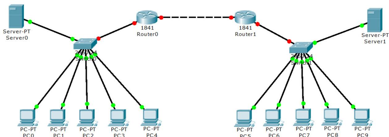
O roteador tem duas portas Fast Ethernet (Fa), cada uma conectada a uma rede. Posicione o mouse (sem clicar) sobre cada enlace que interliga os roteadores. Observe com atenção a identificação de cada uma.
