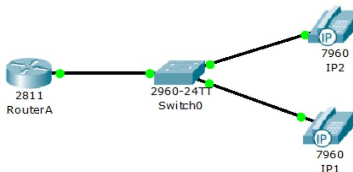
Os telefones IP não irão ligar, pois os switches não tem PoE (*Power over Ethernet*). Abra a visualização (*Physical*) e conecte a fonte de alimentação para cada um deles.
