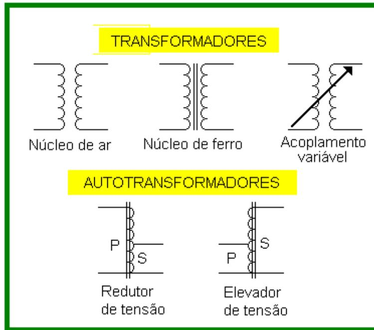
A figura a seguir ilustra uma forma típica de ligação de autotransformador para elevar e reduzir tensão, respectivamente.
