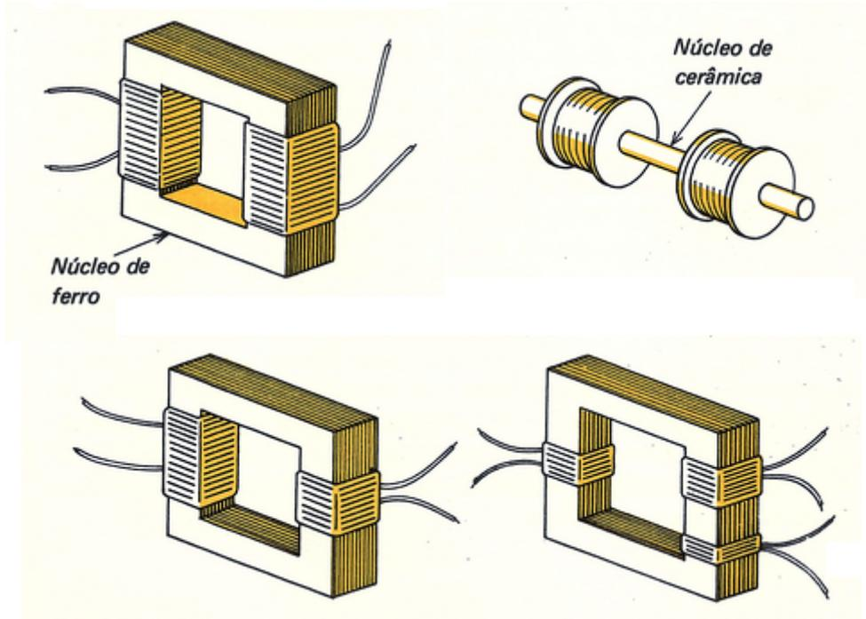
Os núcleos de ferro dos transformadores em sua maioria são confeccionados de lâminas de ferro delgadas de 0,01 a 0,03" (geralmente do tipo grão orientado ou ferro doce) que são empilhadas em direções opostas, formando o núcleo, com a finalidade de diminuir as correntes parasitas e aumentar a eficiência de acoplamento entre o primário e o secundário.
