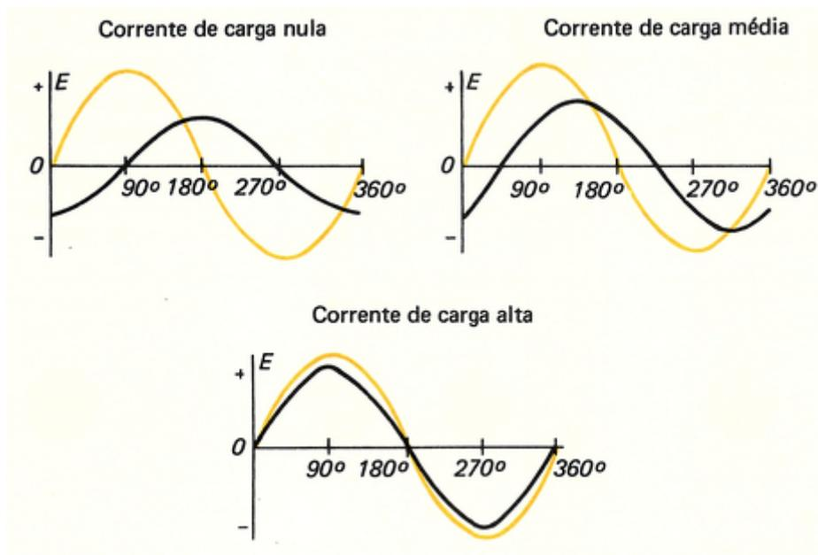
→ Quando a corrente no secundário de um transformador ligado a uma carga resistiva for muito pequena, a corrente e a tensão tanto no primário como no secundário estão defasadas 90°. Quando a corrente na carga cresce (pela diminuição da resistência) a tendência do ângulo de fase entre corrente e tensão tanto no primário como no secundário tende a 0°.
