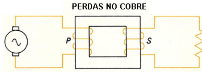
As perdas no cobre ocorrem devido a resistência ôhmica do fio usado nos enrolamentos. É dissipada em forma de calor e pode ser calculada pela fórmula:
