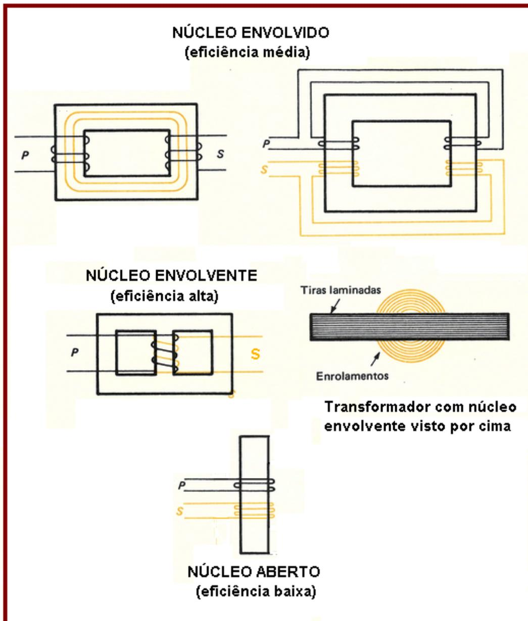
O transformador que usa o núcleo do tipo envolvente é o mais eficaz, visto que os enrolamentos são montados sobre a perna central minimizando as perdas.
