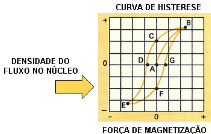
A perda por histerese depende muito do tipo de material usado no núcleo. Ferro de má qualidade retém grande parte da magnetização após a remoção da força de magnetização.
